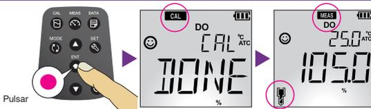
**5. Sumerja el electrodo de O.D. en una solución cero (5 % de sulfito de sodio) y repita los pasos 3-4 para realizar una calibración cero (opcional).**
