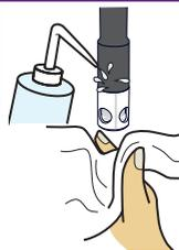
No debe quedar restos de gotas en la membrana ni en el sensor de temperatura.
